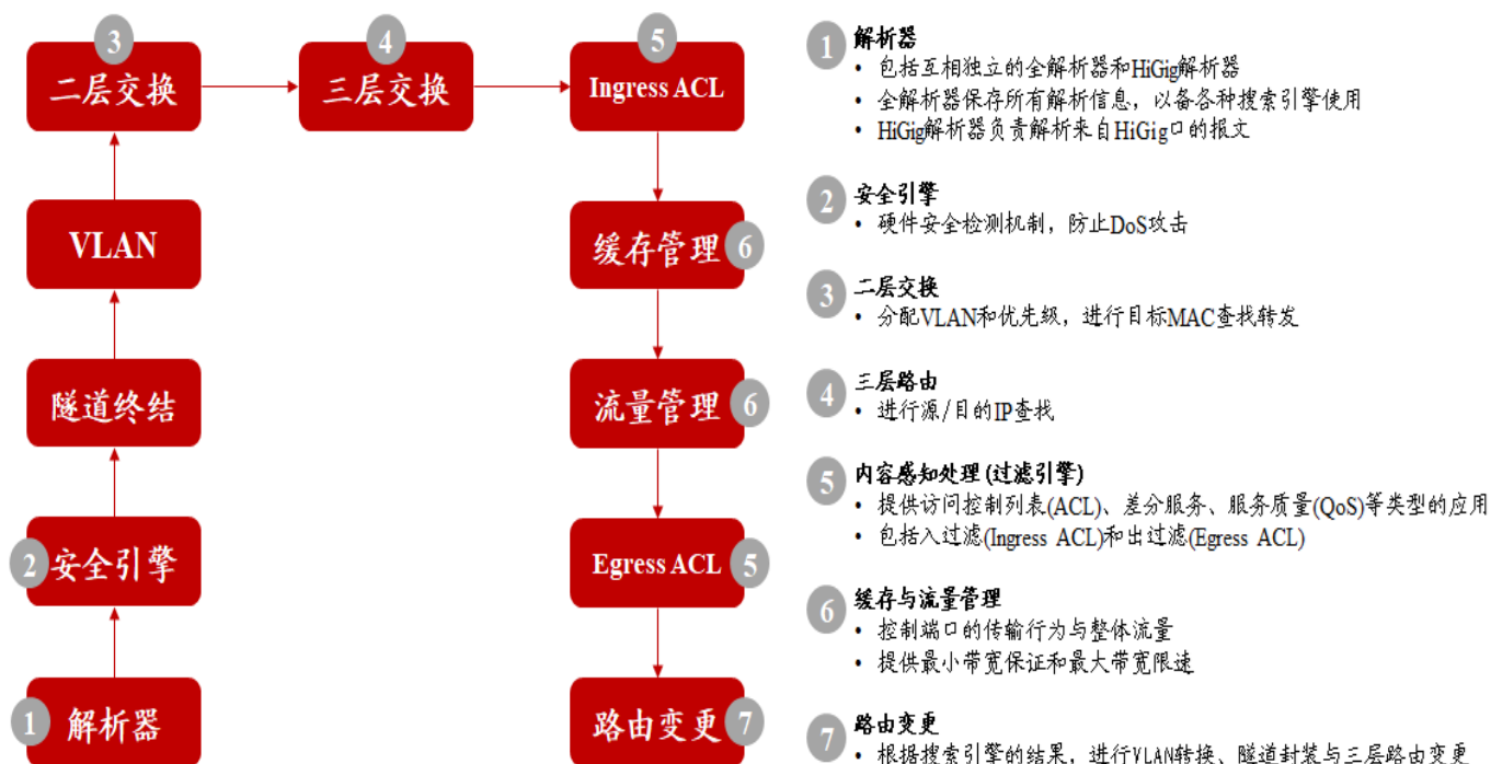
图6：以太网交换芯片报文处理架构
