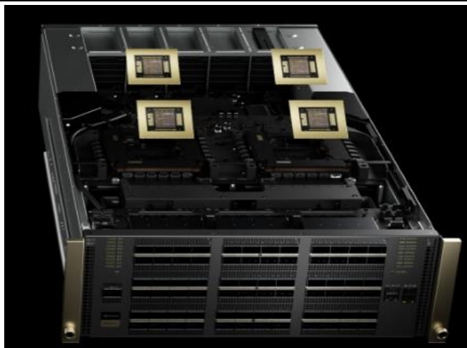
图60：英伟达多芯片盒式交换机包含 72 个 1.6T OSFP 端口
