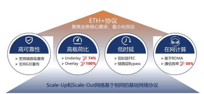
图32：ETH+实现高载荷比、低时延的开放以太网
