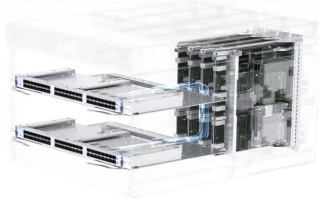
图14：框式交换机正交架构信号传输轨迹
